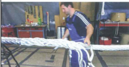
Kraftakt. Beim Spleißen werden die Seilstränge nach einem festen Muster miteinander verflochten.
